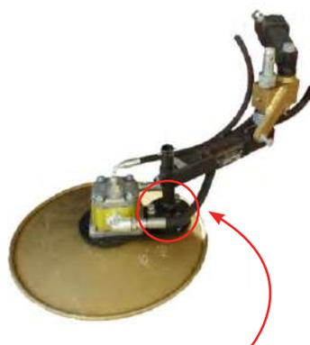
Le réglage de l'inclinaison de la coupelle se fait grâce à un jeu de clé Allen (BTR) en desserrant ces trois vis.
