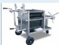
Filtre à plaques Vin/mise stérile Plaque cellulose
